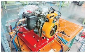
▲図3 ガソリン系エンジン試験装置
