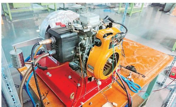
▲図3 ガソリン系エンジン試験装置
